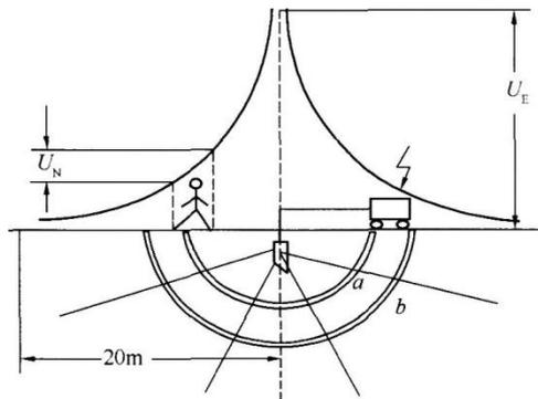
当距离接地体 20m 时，电压曲线趋近于水平，此时对地电压为 0V。故本题应选择 B 选项。
