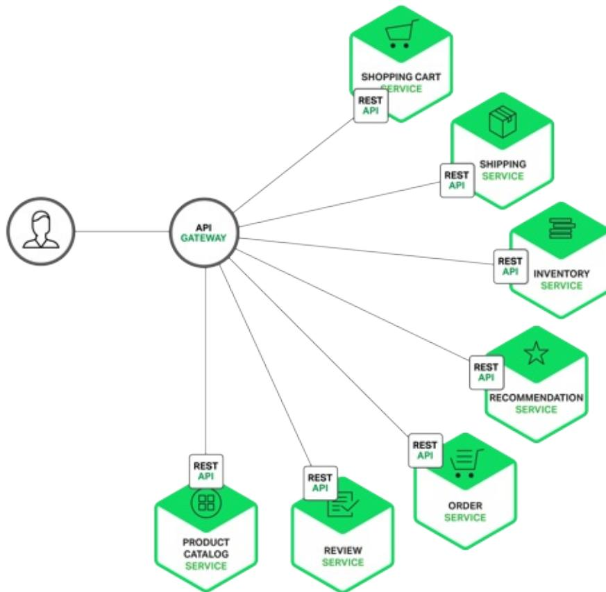
通过API Gateway，可以统一向外部系统提供REST API。Spring Cloud中使用Zuul作为API Gateway。Zuul提供了动态路由、监控、回退、安全等功能。
