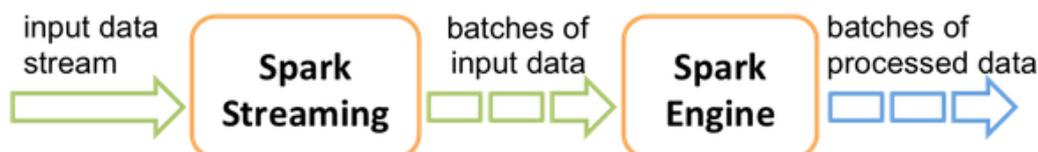
Spark Streaming 提供了一个称为**离散流**或 *DStream* 的高层次的抽象,它代表一个持续的流数据。DStreams 被创建,可以是来自诸如 Kafka、Flume 和 Kinesis 的输入数据流,也可以通过在其他 DStreams 上应用高级操作中创建。在内部,DSTREAM 代表 [RDDs](#) 中的一个序列。
