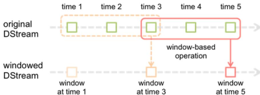
如该图所示，每次当窗口滑动过源 DStream，落入窗口内源 RDDs 被组合和操作时，产生的加窗 DStream 的 RDDs。在此特定情况下，该操作是由 2 个滑动时间单元施加在数据的最后 3 个时间单位。这表明任何窗口操作需要指定两个参数。
