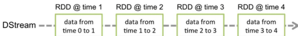
任何在 DStream 上使用的操作都会转化为底层 RDDs 操作。例如，在[前面的示例](#)从行 stream 中转换为单词，在 flatMap 操作是在每个 RDD 施加在 lines DStream 生成的该 RDDs 上的 words DStream。如下图所示。
