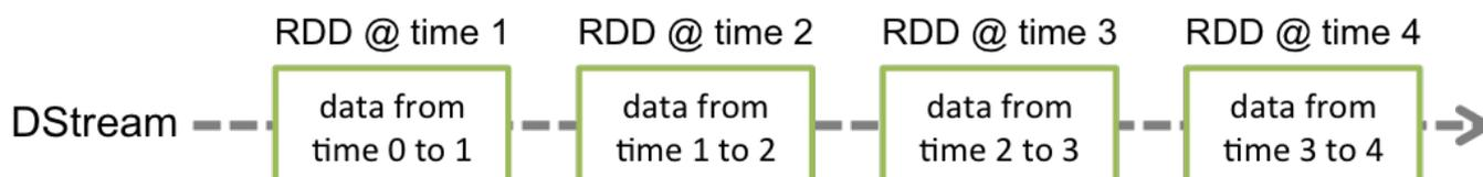
任何对DStreams的操作都转换成了对DStreams隐含的RDD的操作。在前面的例子中，`flatMap` 操作应用于 `lines` 这个DStreams的每个RDD，生成 `words` 这个DStreams的RDD。过程如下图所示：
