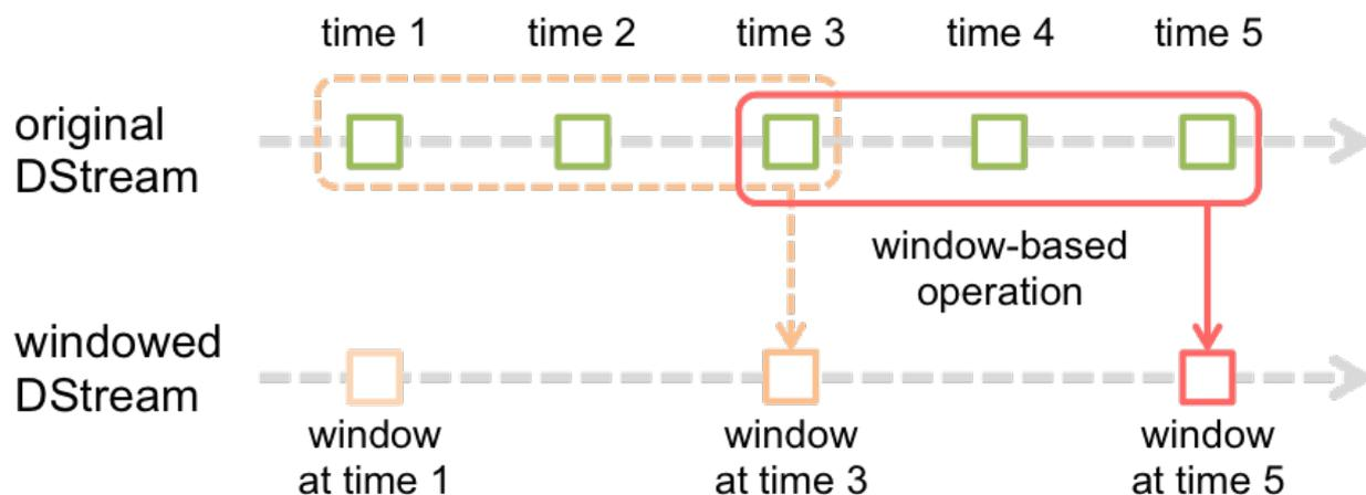
如上图显示，窗口在源DStream上滑动，合并和操作落入窗内的源RDDs，产生窗口化的DStream的RDDs。在这个具体的例子中，程序在三个时间单元的数据上进行窗口操作，并且每两个时间单元滑动一次。这说明，任何一个窗口操作都需要指定两个参数：
