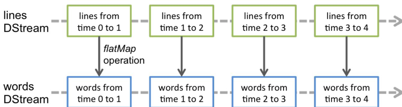
通过Spark引擎计算这些隐含RDD的转换算子。DStreams操作隐藏了大部分的细节，并且为了更便捷，为开发者提供了更高层的API。下面几节将具体讨论这些操作的细节。
