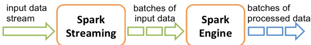
Spark Streaming支持一个高层的抽象，叫做离散流([discretized stream](#))或者 [DStream](#)，它代表连续的数据流。DStream既可以利用从Kafka, Flume和Kinesis等源获取的输入数据流创建，也可以在其他DStream的基础上通过高阶函数获得。在内部，DStream是由一系列RDDs组成。
