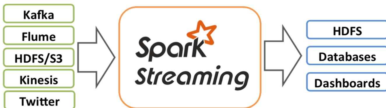
在内部，它的工作原理如下图所示。Spark Streaming接收实时的输入数据流，然后将这些数据切分为批数据供Spark引擎处理，Spark引擎将数据生成最终的结果数据。
